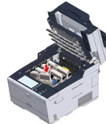
**11** 握住碳粉匣，捏住碳粉匣的藍色鎖定桿 (c) 前端，並向前拉動，直到前端對準碳粉匣的手把為止。
