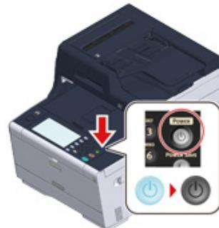
「系統進入關機。狀態 LED 閃爍時，請確認狀態。」訊息在觸控面板上顯示，電源開關 LED 燈將以 1 秒間隔閃爍。
