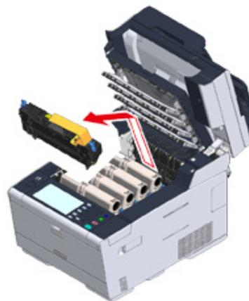
9 推加熱器的藍色鎖定桿，取下橘色安全擋板和遮光紙。
