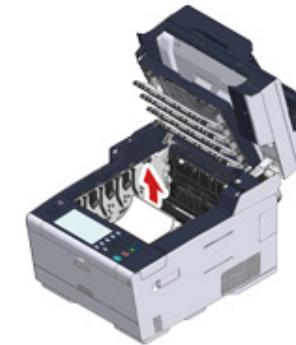
12 握住傳送帶的鎖定桿，並將傳送帶裝入機器中。
