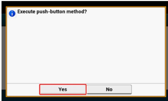
Устройство начнет поиск точек доступа к беспроводной ЛВС. Отобразится следующий экран примерно на 2 минуты, в течение которых необходимо нажать и удерживать кнопку WPS несколько секунд для установки точки доступа к беспроводной ЛВС.
