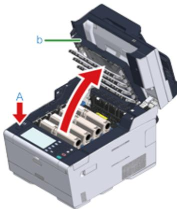
**6** Медленно закройте выходной лоток (b) и нажмите на центральную часть выходного лотка для проверки закрытия.
