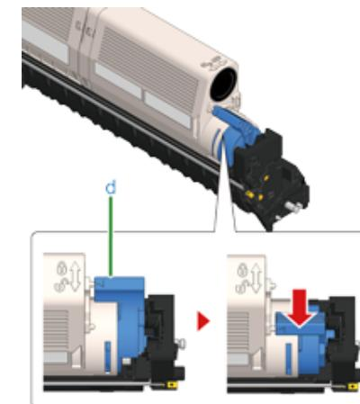
**7** Поднимите тонер-картридж (e) справа и извлеките его из фотобарабана.
