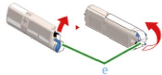
**10** Установите новый тонер-картридж (d), совмещая выемку с левой стороны (f) с выступом (g) на фотобарабане таким образом, чтобы тонер-картридж был выровнен относительно наклейки с указанием цвета на фотобарабане. Затем плотно зафиксируйте правый край.
