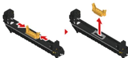
**11** Установите тонер-картридж (e), извлеченный в ходе шага 7, совмещая выемку с левой стороны (f) с выступом (g) на фотобарабане таким образом, чтобы тонер-картридж был выровнен относительно наклейки с
