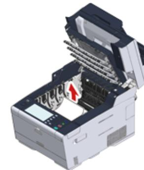
12 Удерживая стопорные рычаги ремня переноса, установите его в устройство.
