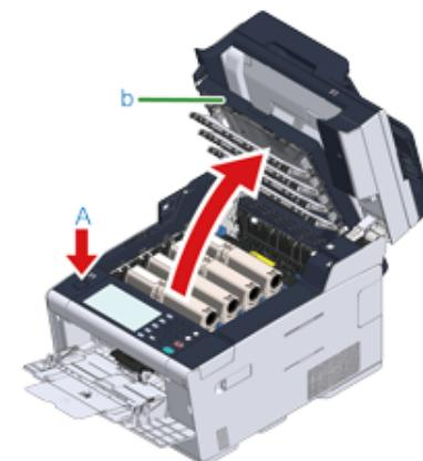
5 Извлеките четыре фотобарабана из устройства и разместите их на ровной поверхности.
