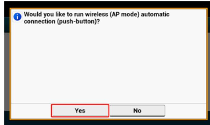
**12** Для подключения к принтеру запустите на беспроводном устройстве операцию WPS-PBC (кнопка).
