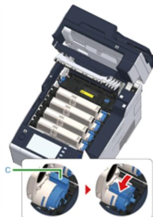
**6** Поднимите тонер-картридж (d) справа и извлеките его из устройства.
