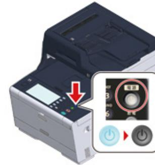
タッチパネル上に、「シャットダウン移行中です LEDが点滅している場合は、ステータスを確認してください。」と表示され、電源スイッチのLEDランプが約1秒周期で点滅します。
