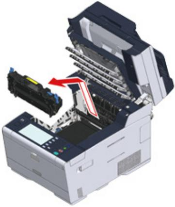
10 ベルトユニット左右のロックレバー（g）を手前側に回し、ロックレバーを持ち、ベルトユニットを取り出します。
