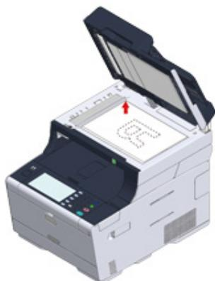
[原稿の画像向き] が縦の場合、原稿の右端とガラスの左上の角を合わせます。
