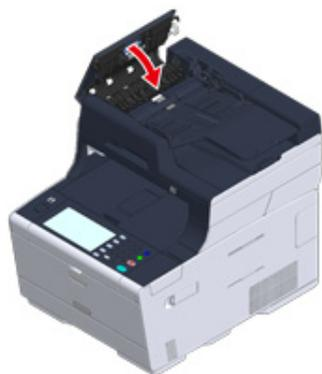
**4** 原稿を表にして自動原稿送り装置にセットします。
