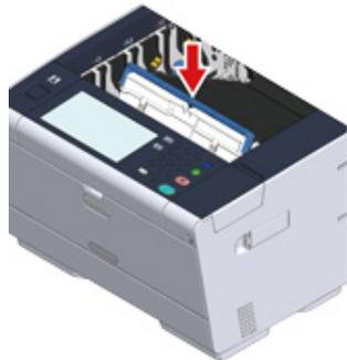
**13** ベルトユニット左右のロックレバー（e）を奥側に回します。
