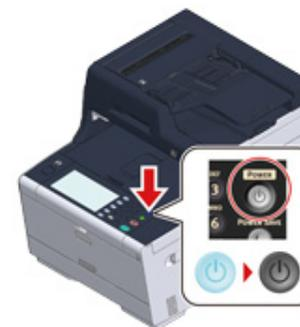
“Il sistema sta per spegnersi. Conferma lo stato quando il LED di stato lampeggia.” si visualizzerà sul pannello touch e il LED dell'interruttore di alimentazione lampeggerà ad intervalli di circa un secondo l'uno dall'altro.
