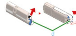
**12** Inserire una nuova cartuccia di toner (d) allineando il rientro sul lato sinistro (f) con la sporgenza (g) sul tamburo fotosensibile in modo che l'etichetta del
