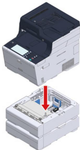
**4** Avvita la macchina e l'ulteriore unità cassetto con i lucchetti.
