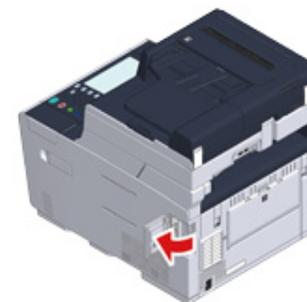
**4** Inserire un'estremità del cavo di rete nel connettore di interfaccia di rete.
