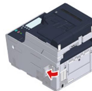
**4** Inserte un extremo del cable de la LAN en el conector de interfaz de la red.
