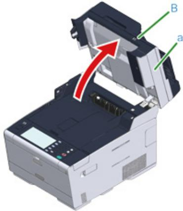
**3** Pulse el botón (A) y abra la bandeja de salida (b) completamente.
