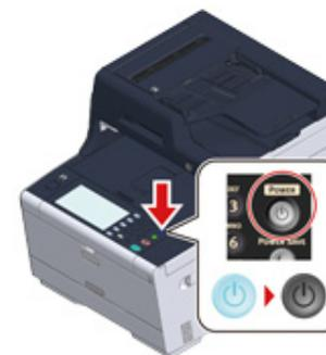
El "Sistema pasa a apagarse. Confirme el estado cuando LED de estado parpadea". Aparece el mensaje en el panel táctil y la lámpara LED del interruptor de la alimentación parpadea en intervalos de un segundo aproximadamente.
