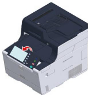
Para configurar el panel del operador de nuevo en la posición original, extraiga el panel del operador hasta que se detenga y luego empuje lentamente.
