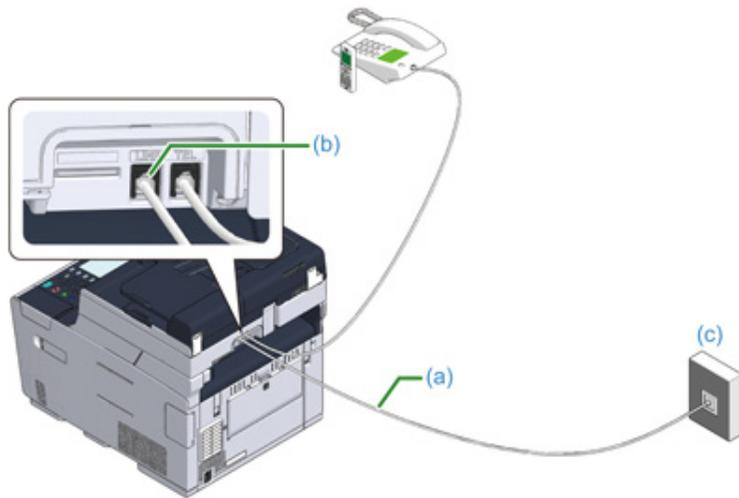
**1** Conecte uma extremidade do cabo de telefone (a) incluso no conector LINE (b) da máquina e a outra extremidade em uma linha pública (analógica) (c).
