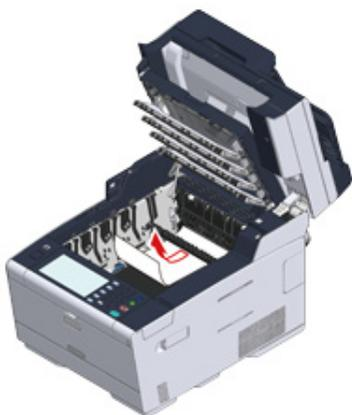
11 Segure a alça da unidade fusora e posicione a unidade fusora na máquina.
