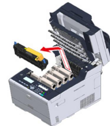
9 推加熱器的藍色鎖定桿，取下橘色安全擋板和遮光紙。
