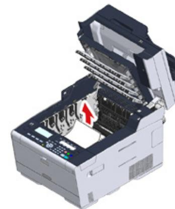
12 握住傳送帶的鎖定桿，並將傳送帶裝入機器中。
