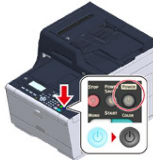
「系統進入關機。狀態 LED 閃爍時，請確認狀態。」訊息在操作面板上顯示，電源開關 LED 燈將以 1 秒間隔閃爍。
