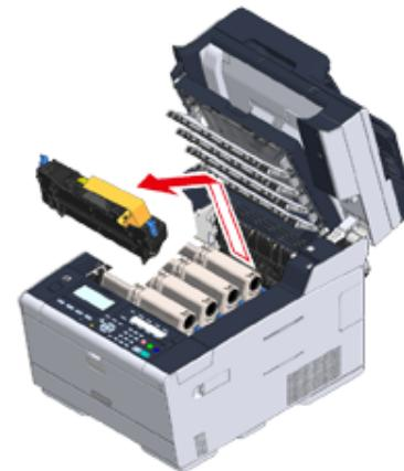
**9** Сдвиньте синий рычажок на печке, а затем извлеките оранжевый предохранительный ограничитель и пленку.
