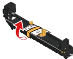
**10** Снимите крышку тонера.
