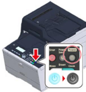
A mensagem "Sist.move-se para o des. Fav. conf. status quando LED de status estiver piscando." é exibida no painel de toque, e a lâmpada de LED da chave de energia pisca em intervalos aproximados de um segundo.
