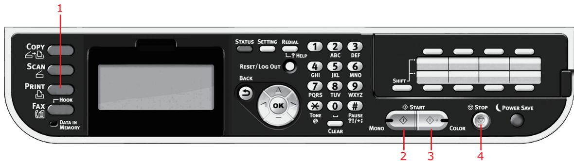
2. 使用 **Down** ( 向下 ) 鍵將畫面捲動至**切換連線 / 離線** ( Switch Online/Offline )，然後按下 **OK** ( 確定 )。
