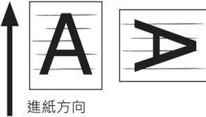
進紙方向     | 若線或點の間隔約為 94 公釐 (4 英吋)，表示感光鼓 (綠筒) 已損壞或髒污。 | 請用柔軟面紙擦拭感光鼓。<br>若感光鼓損壞，請更換感光鼓。                                                              | 第 104 頁 |
