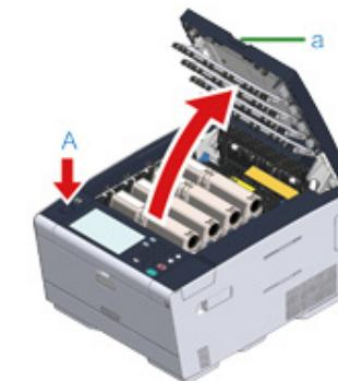
5 捏住碳粉匣的藍色鎖定桿前端，並向前拉動，直到前端對準碳粉匣的手把為止。
