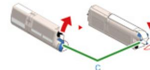
**11** 將新碳粉匣 (d) 左側的凹口 (e) 對齊感光鼓上的突出部分 (f)，以插入新的碳粉匣，使碳粉匣和感光鼓的顏色標籤對齊，然後將右側輕輕插入至定位。
