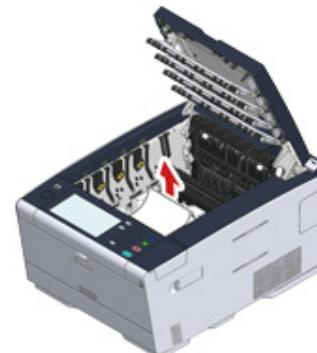
10 握住傳送帶的鎖定桿，並將傳送帶裝入機器中。
