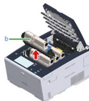
5 握住碳粉匣，捏住碳粉匣的藍色鎖定桿 (c) 前端，並向前拉動，直到前端對準碳粉匣的手把為止。
