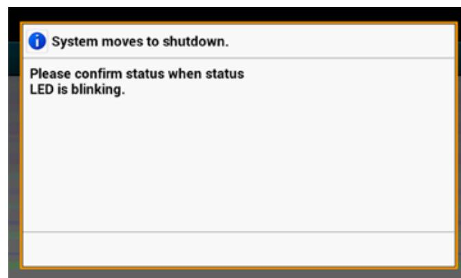
一段時間後機器將自動關閉電源，電源開關 LED 燈也將熄滅。
