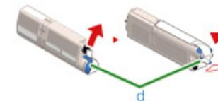
9 將新碳粉匣 (c) 左側的凹口 (e) 對齊感光鼓上的突出部分 (f)，以插入新的碳粉匣，使碳粉匣和感光鼓的顏色標籤對齊，然後將右側輕輕插入至定位。
