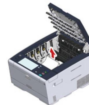
11 捏住傳送帶的鎖定桿，並將傳送帶裝入機器中。
