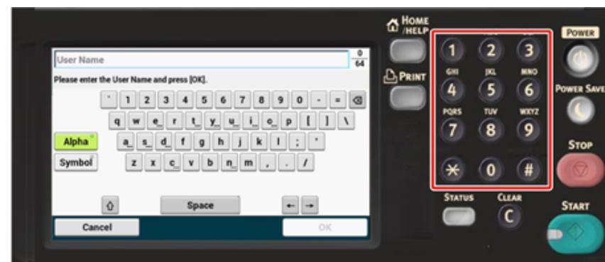
Можно вводить цифры, обозначенные на каждой кнопке.
