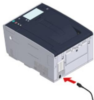
2 Inserire il cavo di alimentazione nella presa di corrente.
