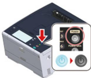
El "Sistema pasa a apagarse. Confirme el estado cuando LED de estado parpadea". Aparece el mensaje en el panel táctil y la lámpara LED del interruptor de la alimentación parpadea en intervalos de un segundo aproximadamente.
