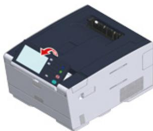
Para configurar el panel del operador de nuevo en la posición original, extraiga el panel del operador hasta que se detenga y luego empuje lentamente.
