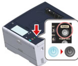
Die Meldung "System moves to shutdown. Bitte bestätigen Sie den Status, wenn Status-LED blinkt. "Das System beginnt mit dem Abschalten. Bitte bestätigen Sie den Status, wenn die LED blinkt" wird auf dem Bedienfeld angezeigt und die LED-Lampe des Stromschalters blinkt in Abständen von ca. einer Sekunde.
