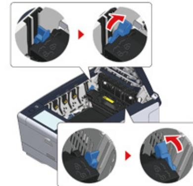
**14** Die vier Bildtrommeln zurück in das Gerät setzen
