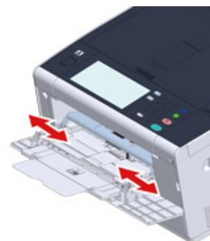
**5** Sørg for, at papirtilførselsrullen bliver på den korrekte placering.
