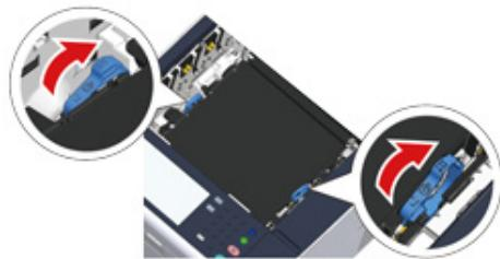
**13** Uchopte fixační jednotku za držadlo a vložte ji do tiskárny.
