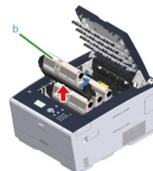
5 握住碳粉匣，捏住碳粉匣的藍色鎖定桿 (c) 前端，並向前拉動，直到前端對準碳粉匣的手把為止。
