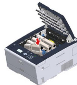
**10** 握住碳粉匣，捏住碳粉匣的藍色鎖定桿 (b) 前端，並向前拉動，直到前端對準
