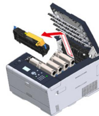
8 推加熱器的藍色鎖定桿，取下橘色安全擋板和遮光紙。
