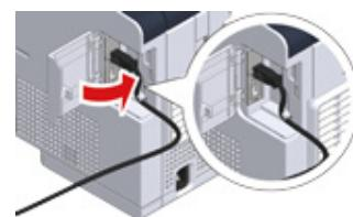
6 將 USB 連接線一端插入機器的 USB 介面接頭。
