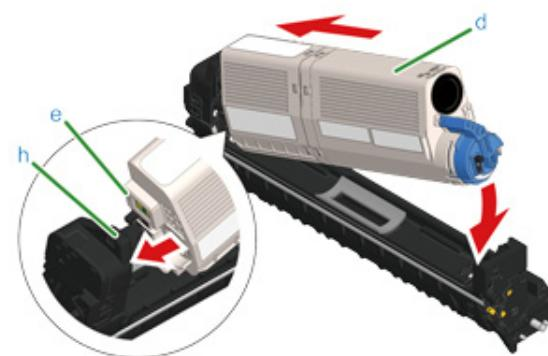
11 握住碳粉匣，捏住碳粉匣的藍色鎖定桿 (g) 前端，並向前拉動，直到前端對準碳粉匣的手把為止。
