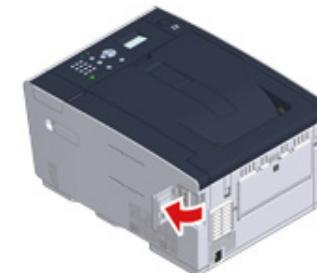
**4** 將 USB 連接線一端插入機器的 USB 介面接頭。
