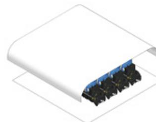
5 打開機器內部的透明蓋，拉動紙張的邊緣，慢慢取出紙張。
