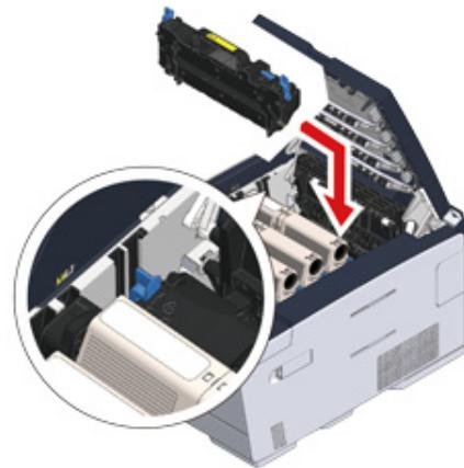
10 推動加熱器的鎖定桿來鎖定。
