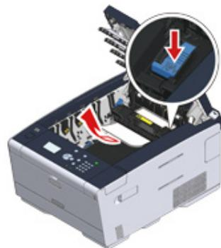
9 朝您推傳送帶兩側的鎖定桿，並握住鎖定桿取下傳送帶。
