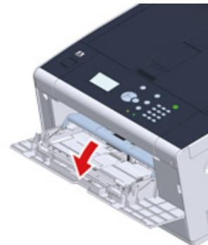
**2** 按壓托紙架的中間部分，將托紙架拉出。
