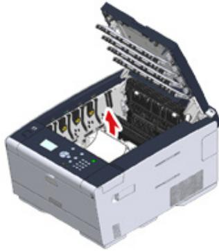
**11** Tenez les leviers de verrouillage de la courroie et placez la courroie dans la machine.
