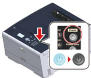
El mensaje "Apagando. Espere, por favor. La impresora se apagará automáticamente." se muestra en la pantalla y la lámpara LED del interruptor de la alimentación parpadea en intervalos de un segundo aproximadamente.
