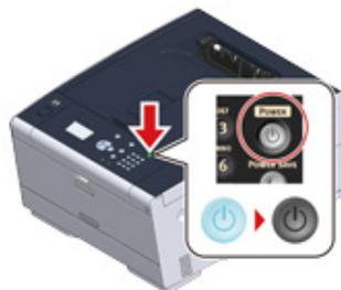
Die Meldung „Herunterfahren. Bitte warten. Der Drucker schaltet sich automatisch ab.“ ist auf der Anzeige zu sehen und die LED des Netzschalters blinkt im Intervall von ca. 1 Sekunde.
