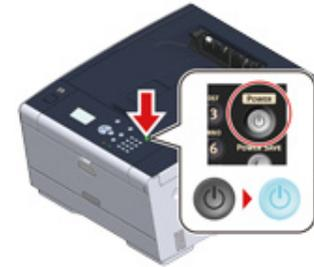
Wenn das Gerät eingeschaltet ist, leuchtet die LED des Netzschalters.
