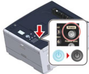
"Lukning. Vent venligst. Printeren slukker automatisk." beskeden vises på display skærmen og tænd-sluk-knappens LED lampe blinker med et interval på cirka ét sekund.
