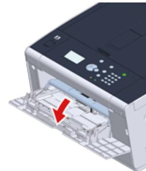
**2** 握住撑纸板的中间位置，拉出撑纸板。
