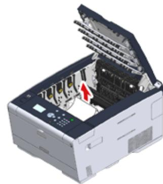
11 握住转印皮带的锁定杆，将转印皮带装入设备。
