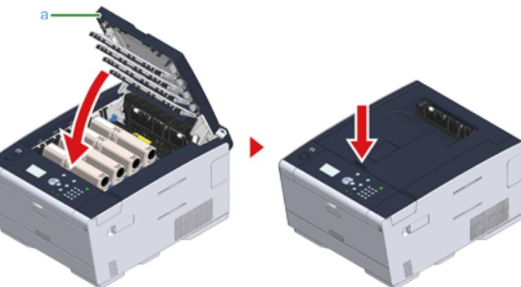
如果出纸架打开的错误消息仍未消失，确保出纸架已完全合上。
