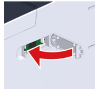
转到“连接电源线”。
