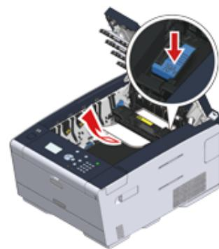
7 朝您所在方向向后斜推两侧的锁定杆。
