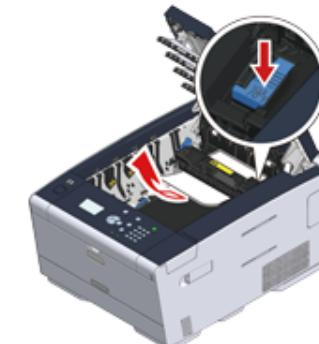
6 朝您所在方向向后斜推两侧的锁定杆 (c)。
