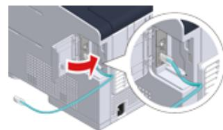
**6** 将局域网电缆的另一端插入集线器中。
