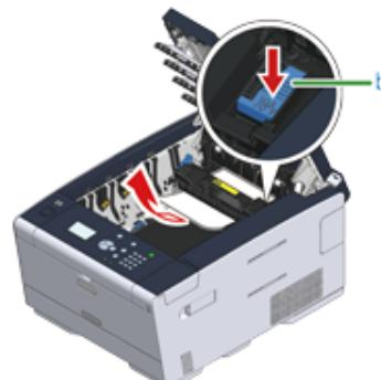
6 朝您所在方向向后斜推两侧的锁定杆。
