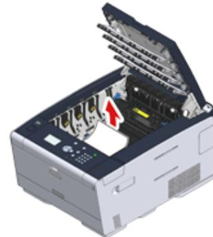
5 如果定影器内发生卡纸，按定影器卡纸释放杆 (b)，然后朝您所在方向缓慢地拉出卡纸。
