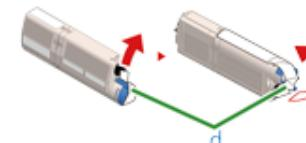
9 将墨粉盒左侧的凹槽 (e) 对准感光鼓的突出部分 (f)，插入新的墨粉盒 (c)，确保墨粉盒与感光鼓的颜色标签对齐。然后，轻轻地将其右侧插入到位。
