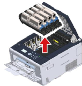
4 为避免感光鼓暴露在光线下，应使用纸张覆盖拆除的感光鼓。
