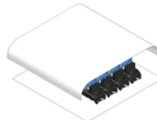
5 打开设备内部的透明盖，拉动纸张边缘，缓慢地取出卡纸。
