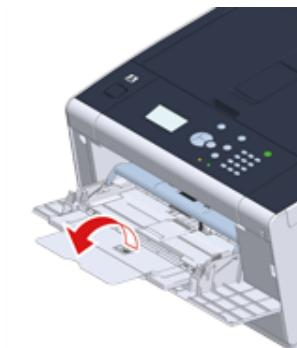
**4** 将手动送纸导纸板调整至要装入纸张的宽度。
