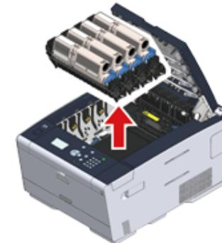
3 为避免感光鼓暴露在光线下，应使用纸张覆盖拆除的感光鼓。
