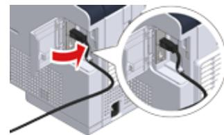
6 将 USB 电缆的一端插入设备的 USB 接口中。
