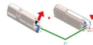
**11** 将墨粉盒左侧的凹槽 (d) 对准感光鼓的突出部分 (f)，插入新的墨粉盒 (c)，确保墨粉盒与感光鼓的颜色标签对齐。然后，轻轻地将其右侧插入到位。
