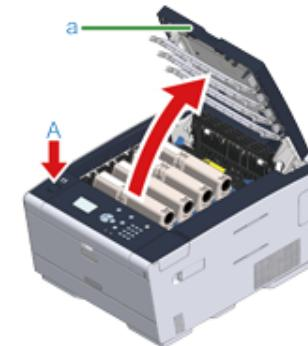
2 请用柔软的纸巾轻轻擦拭 LED 打印头的四个透镜。
