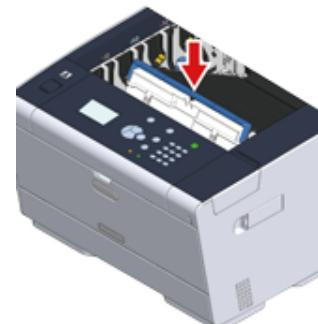
12 向前方转动转印皮带两侧的锁定杆。
