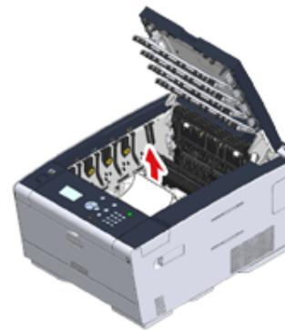
10 握住转印皮带的锁定杆，将转印皮带装入设备。
