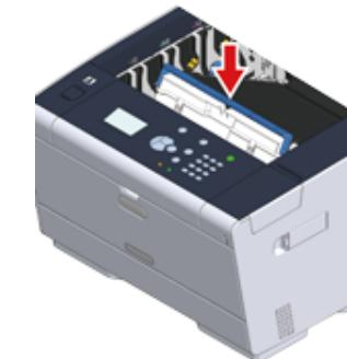
11 向前方转动转印皮带两侧的锁定杆。
