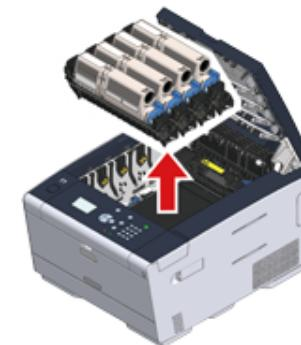
4 为避免感光鼓暴露在光线下，应使用纸张覆盖拆除的感光鼓。
