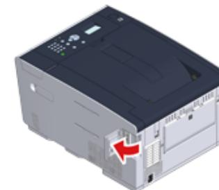
**4** 将 USB 电缆的一端插入设备的 USB 接口中。
