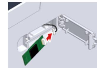
**4** 将无线局域网模块安装到设备中。
