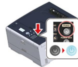
Po zapnutí přístroje se rozsvítí kontrolka LED hlavního vypínače.
