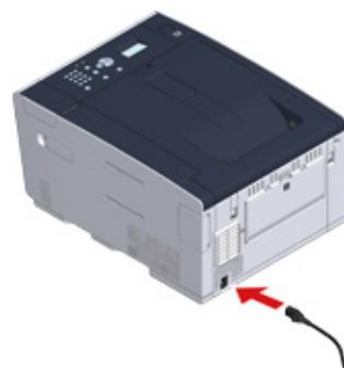
2 Napájecí kabel zapojte do zásuvky.
