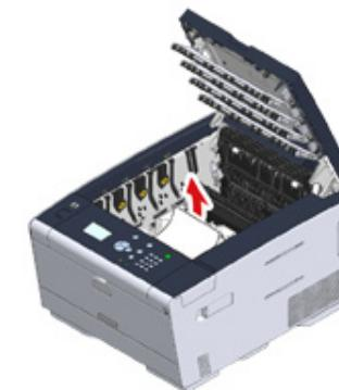
**11** Přidržte uzamykací páčky pásové jednotky a vložte pásovou jednotku do přístroje.
