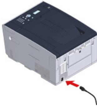
2 Conecte o cabo de força na tomada.
