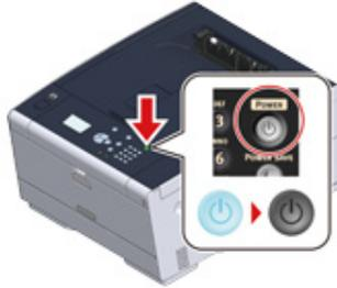
A mensagem "Desligando. Aguarde. A impressora desligará automaticamente." é exibida na tela de exibição e a lâmpada de LED de interruptor de energia piscará em intervalos aproximados de um segundo.
